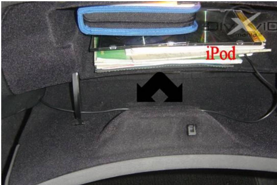
Il cavo in eccedenza si può fissare dietro la plancia senza accorgimenti particolari, basta regolare la lunghezza tirando il cavo dal lato dell'Ice>Link.
